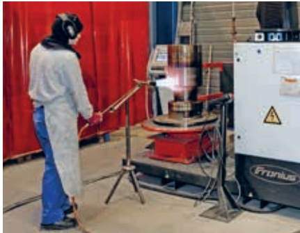
Potences pour le rechargement par soudage horizontal et vertical jusqu'à Ø 900 mm, soudage inter et exter jusqu'à 900 mm de hauteur.
