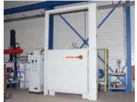
Après rechargement, les pièces subissent un traitement thermique dans notre four de détentionnement pour éliminer les contraintes liées à la soudure.
