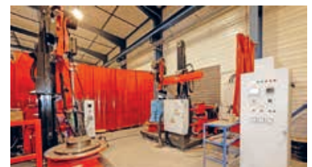
2 Potences de rechargement CCC FRONIUS (TIG fil chaud)
