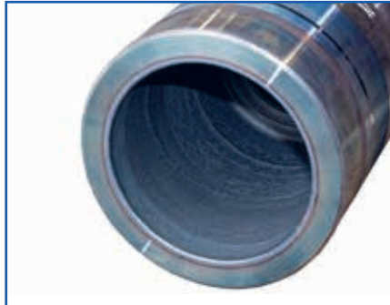
Exemple de pièce rechargée à l'Inconel 625 sur acier 4130 faiblement allié.
