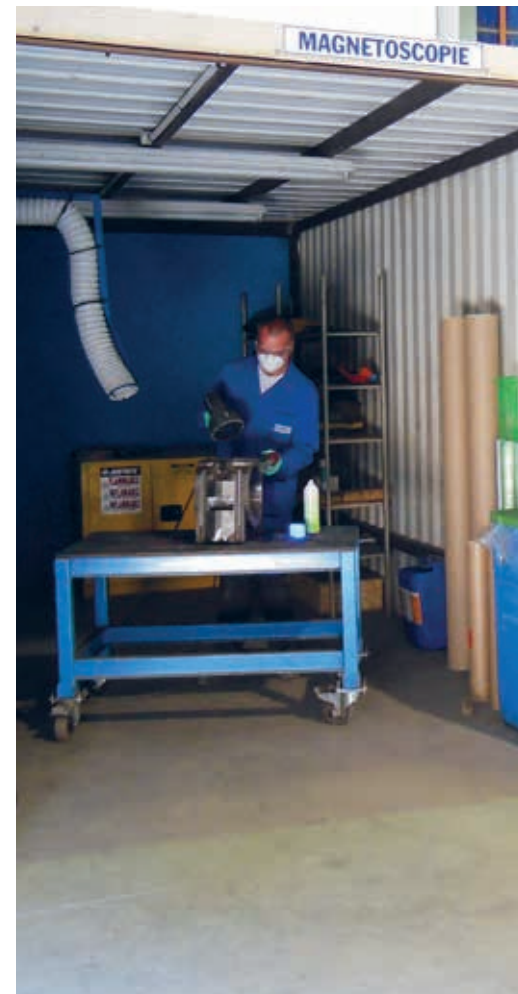
Cabine dédiée au contrôle magnétoscopique, nos contrôleurs étant qualifiés COFREND II
