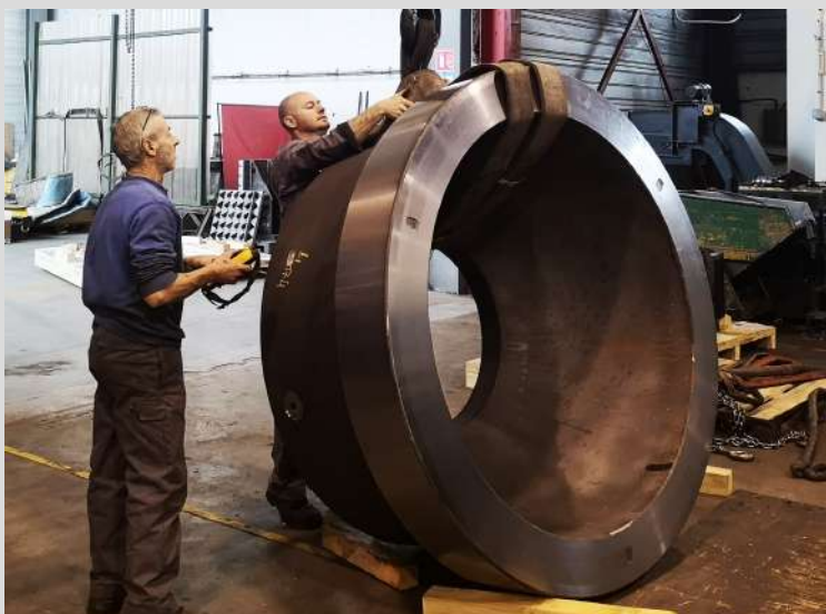
Frédéric BONNIN et Cyrille STOOS déchargent une pièce de \varnothing 1900\text{mm} (charge : 6200kg)
